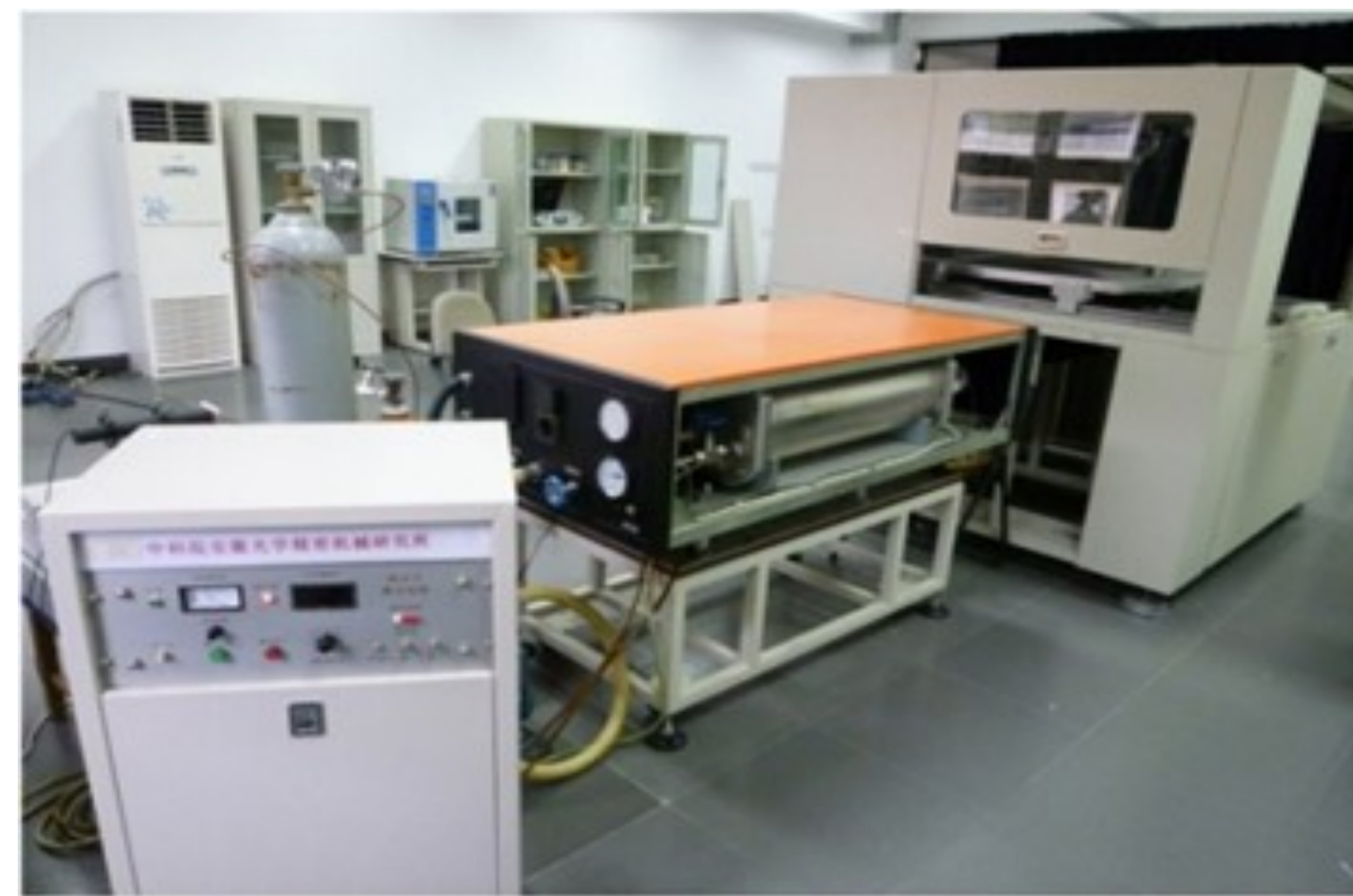
用于印刷电路板制造工艺的准分子激光设备
