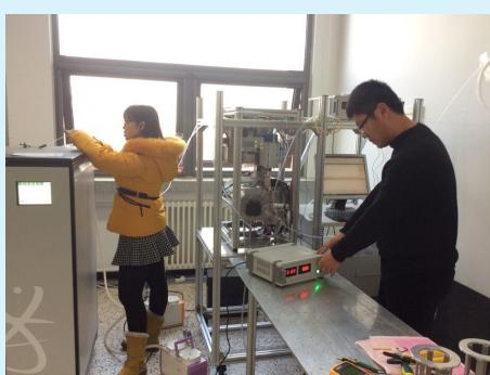
2015年1月,研究室仪器研制小组在常州进行了为期近一个月外场实验工作。右图中,彭秀球、徐康明两位研究生正在进行光电子成像能谱仪(PEI)的设备调试工作。
